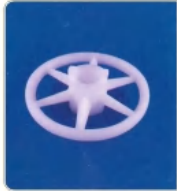
品名: Φ50滚轮片 规格: Φ50×Φ10×15L×5W平面 材质: PP 编号: CT-LP-156
