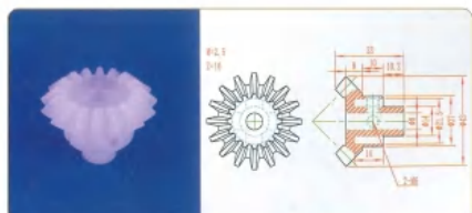
品名: 16齿伞齿轮 规格: M2.5×16Z×33L 材质: PVDF 编号: CT-SCL-031
