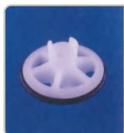
品名: \Phi 50 滚轮片 规格: \Phi 50 \times \Phi 12 \times 33L \times 7W 弧面 材质: PP+EPDM 编号: CT-LP-220
