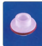
品名: \Phi 40 滚轮片 规格: \Phi 40 \times \Phi 16 \times 28L \times 7W 弧面 材质: 铁氟龙+砂胶 编号: CT-LP-209
