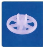
品名: Φ40滚轮片 规格: Φ40×Φ10×20L×5W弧面 材质: PE 编号: CT-LP-104
