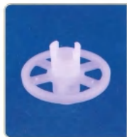
品名: Φ40滚轮片 规格: Φ40×Φ10×24L×3W平面 材质: PP 编号: CT-LP-108
