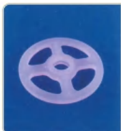
品名: Φ49滚轮片 规格: Φ49×Φ9.8×6L×3W平面 材质: PP/PVDF 编号: CT-LP-148
