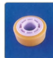
品名: \Phi 40 滚轮片 规格: \Phi 40 \times \Phi 16 \times 17.5L \times 17.5W 平面 材质: PP+TPU 编号: CT-LP-208
