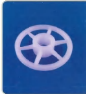
品名: Φ50滚轮片 规格: Φ50×Φ12.4×12L×5W平面 材质: PP 编号: CT-LP-165
