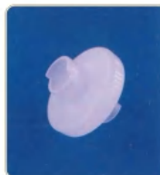
品名: Φ32滚轮片 规格: Φ32×Φ10×23L×6W平面 材质: HCPP 编号: CT-LP-054
