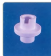
品名: Φ32滚轮片 规格: Φ32×Φ12.6×30L×5W平面 材质: PP/PVDF 编号: CT-LP-061
