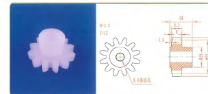
品名: 12齿32直齿轮 规格: M2×12Z 材质: PVDF 编号: CT-ZCL-034
