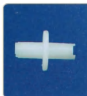
品名: Φ32滚轮片 规格: Φ32×Φ10×45L×3.5W平面 材质: PP 编号: CT-LP-059
