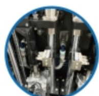
升降采用4导柱及4直线轴承结构，升降平稳顺畅
