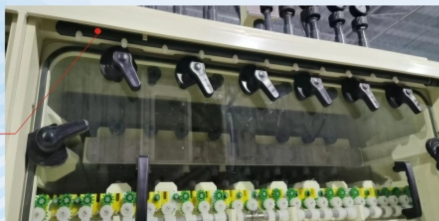
自动清洗玻结晶物，设备会定时设定时间喷淋
