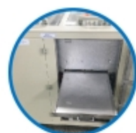
1. 烘干段抽屉式垃圾收集盒设计, 方便保养; 2. 烘干段外包PP设计, 保温效果好, 高效节能;
