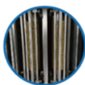
上压轴、钢轴自动追踪板位置,自动抬升系统,可研磨板厚0.15~10.0MM
