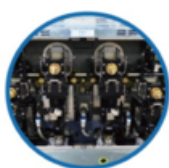
下上下下磨刷结构与精密蜗轮输送系统,可输送极薄板与厚板,保证输送稳定性
